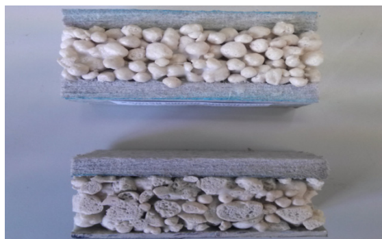
10 дугаар зураг. Хөөсөн шилэн дулаалгын үетэй ханын хавтан
