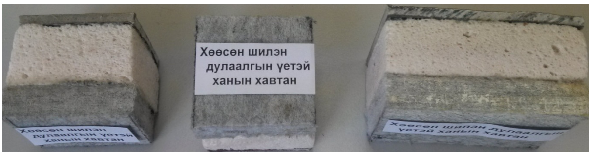
10 дугаар зураг. Хөөсөн шилэн дулаалгын үетэй ханын хавтан
