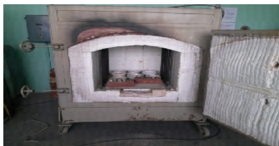
Хөөсөн шилний шатаалтын туршилт гүйцэтгэсэн шатаах зуух
