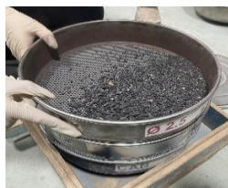
3-р зураг. Туршилтад ашигласан материалын 1.25 болон 2.5 мм-ийн диаметртэй шигшүүрээр шигшихээс өмнөх байдал.
