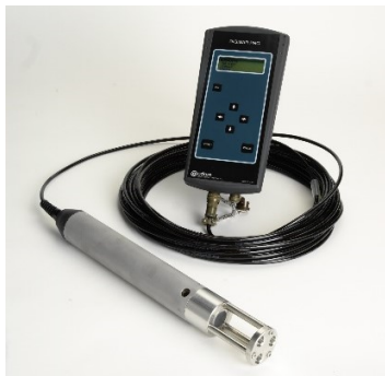
5-р зураг. Усан дотор дууны долгионы хурдыг хэмжэдэг багаж
