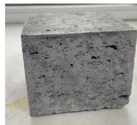
7-р зураг. Сайжруулсан шахмал түлшнээс гаргаж авсан хөнгөн дүүргэгчтэй бетон туршсан байдал
