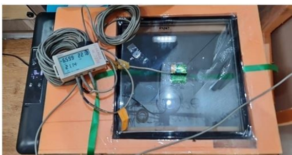
3-р зураг. Дулаан дамжуулалтын үзүүлэлт тодорхойлох багажсийн харагдах байдал
