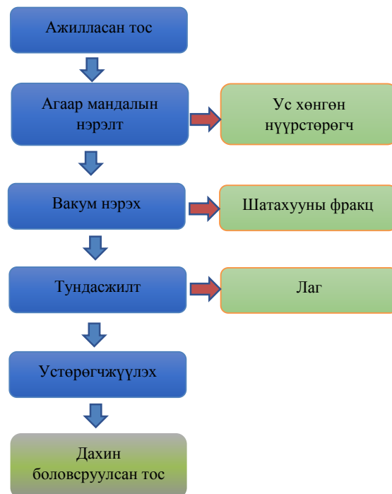
3-р схем вакум нэрэх усгүйжүүлэх арга
