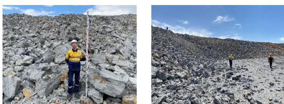
1-р зураг. Судалгаанд хамрагдсан тэслэгдсэн блокийг хэмжсн буй байдал
