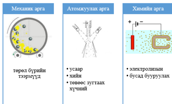
1-р зураг. Металл нунтаглах аргууд (а. Бөмбөрцөгт тээрэм б. атомжуулалт в. Электролизын арга)
