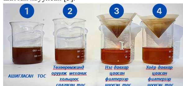
4-р зураг. Шүүлтүүрээр шүүсэн тосны цэвэршилт харьцуулалт
