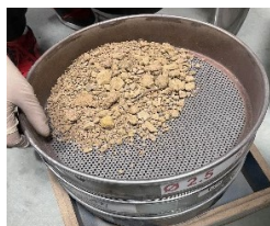
3-р зураг. Туршилтад ашигласан материалын 1.25 болон 2.5 мм-ийн диаметртэй шигшүүрээр шигшихээс өмнөх байдал.
