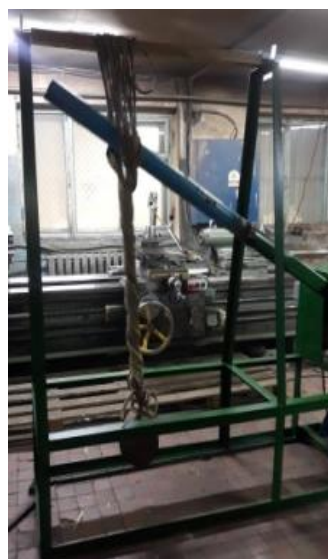
Зураг 3.24. Монгол ардын сур элдэх уламжлалт технологийн гар ажиллагааг механикжуулж төхөөрөмж
