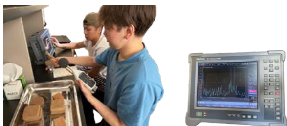
3-р зураг. Өмхөрсөн шинэсэн шахмал хавтангийн уян харимхайн модулийн үл эвдэх сорил
