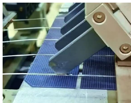
Зураг 1. 7 Бүрхүүл дээр металл электрод суулгах.
