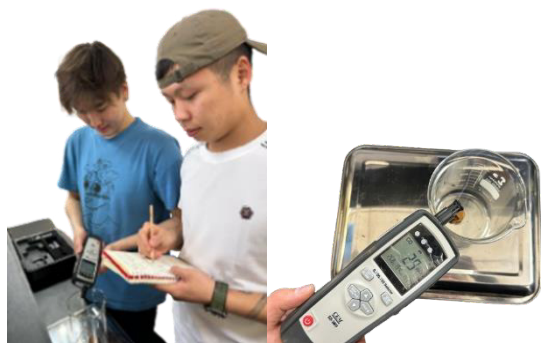
2-р зураг. Олон үйлдэлт хий хэмжигчийн туршилт ( O_2 , CO_2 , CO , t^\theta )
