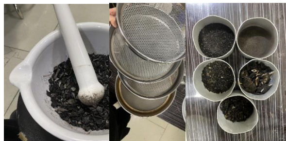
Зураг 2.Боловсруулсан ясаа буталж шүүлтүүр ашиглаж ширхгээр нь таван хэсэгт хуваасан
