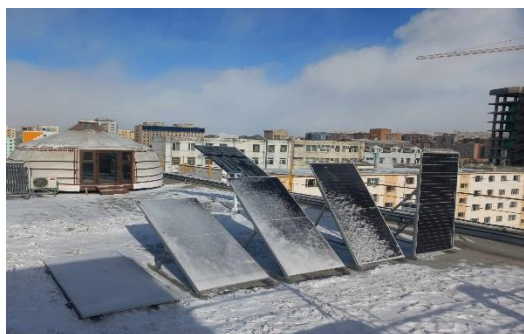
1-р зураг. 2025.02.05-ны өдөр нарны хавтангийн налалтын өнцгөөс хамааран цас тогтсон байдал
