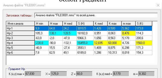
Зураг 16. №2101 автосамосвалын доод рамны баруун гуянд хийсэн 1-р хэмжилтийн дүнд анализ хийсэн байдал (хэмжилтийн канал бүрээр)
