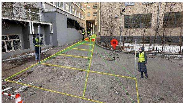
5-р зураг. Багажийн нэг түвшинээр квадратуудын оройн цэгүүдээс тоолол уншиж буй ажлын явцын зураг
