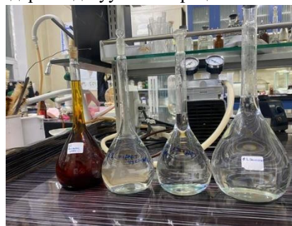
Зураг 6. Усны фтор тодорхойлоход шаардагдах урвалж. Баруун талаасаа/Ализарин улаан С,Фторт натрийн үндсэн стандарт уусмал, Фторт натрийн ажлын стандарт уусмал,Оксихлорид цирконил/
