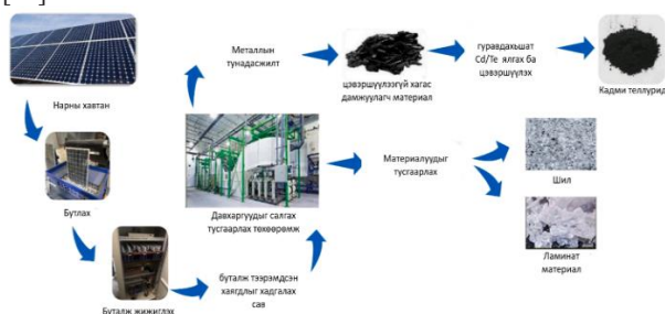
Зураг 1.10 Механик дахин боловсруулалтын процесс.
