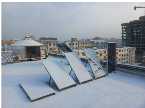
2-р зураг. 2025.03.12-ны өдөр нарны хавтангийн налалтын өнцгөөс хамааран цас тогтсон байдал
