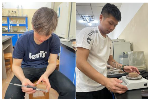
4-р зураг. Өмхөрсөн шинэсэн шахмал материалын нягтыг тодорхойлох туршилт
